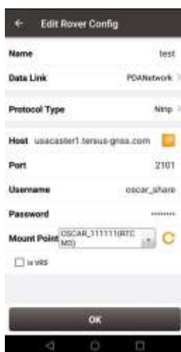
Рисунок 4.16 Настройка ровера – Сеть контроллера (КПК) (Ntrip)
